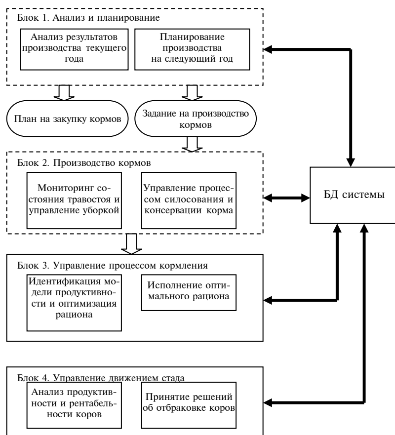
Рис. 5. Блок-схема автоматизированной системы производства молока.
