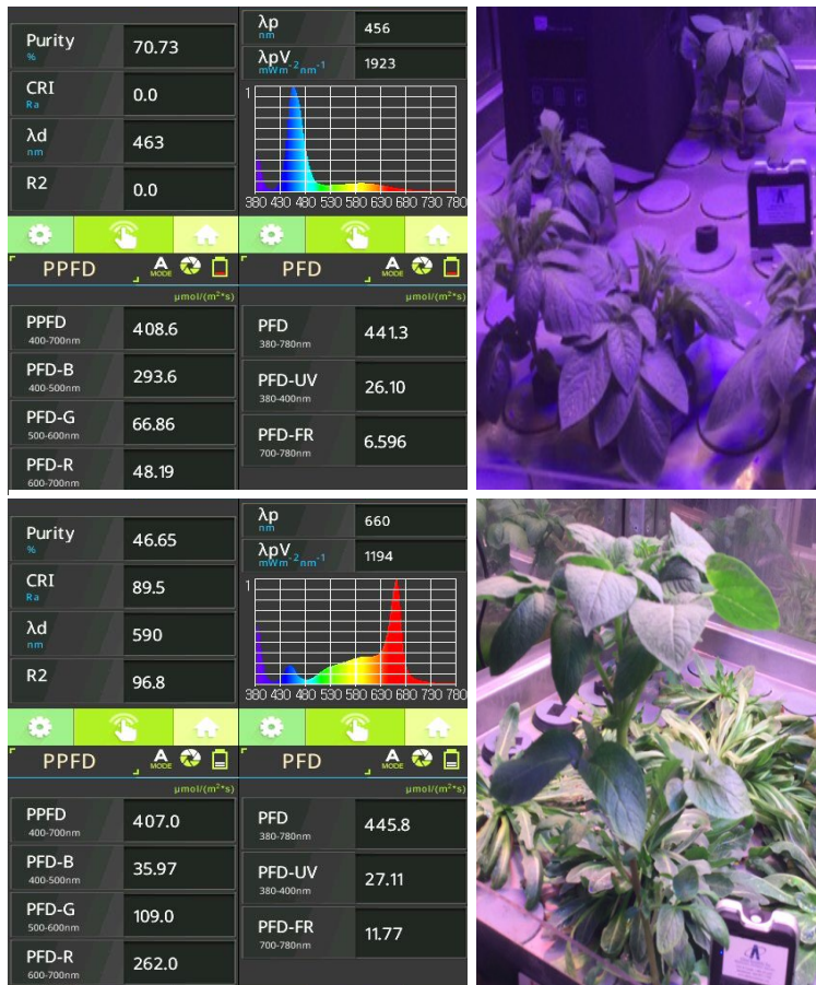
Рис. 1. Спектральные характеристики камер фитотрона. ФАР + СС (синий свет, сверху): общий поток фотонов — 408,6 \text{ мкмоль} \cdot \text{м}^{-2} \cdot \text{с}^{-1} , синий и красный участки спектра — соответственно 293,6 и 48,19 \text{ мкмоль} \cdot \text{м}^{-2} \cdot \text{с}^{-1} ; ФАР + КС (красный свет, внизу): общий поток — 407,0 , красный и синий участки спектра — соответственно 262,0 и 35,97 \text{ мкмоль} \cdot \text{м}^{-2} \cdot \text{с}^{-1} .
